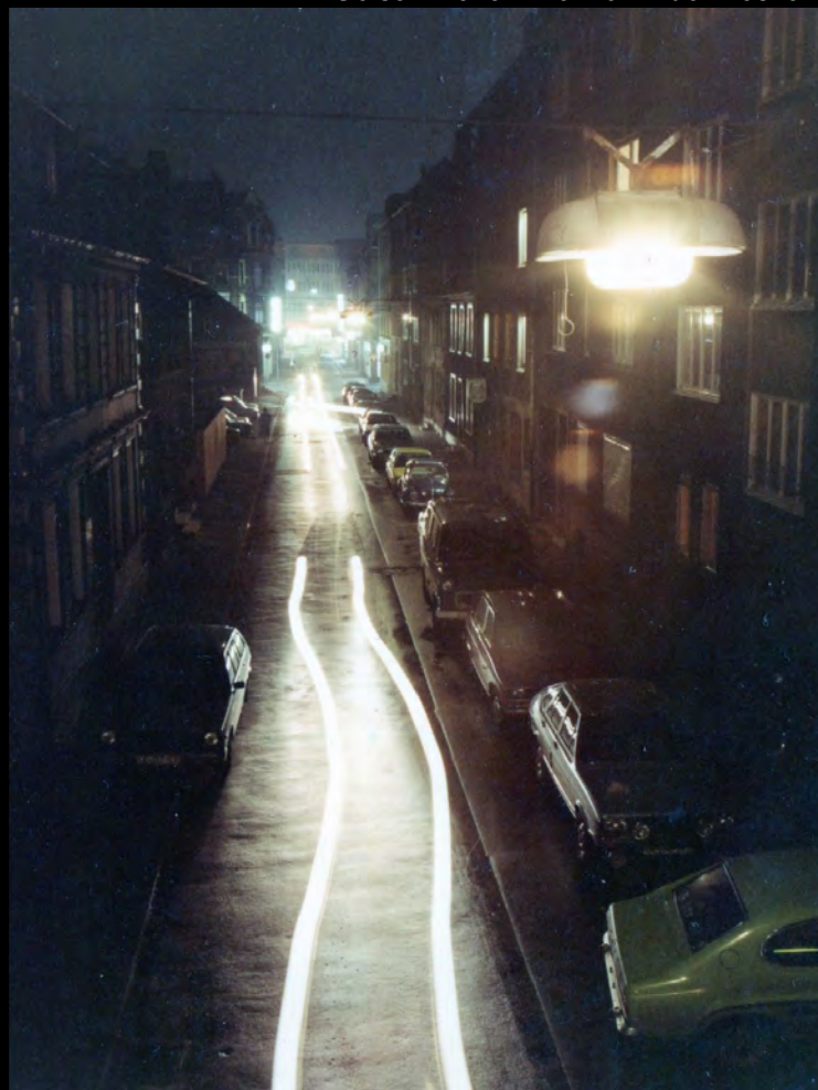
Bis Mitte der 1980er Jahre konnte man in Gelsenkirchen Gashängeleuchten bestaunen, die an Überspannungen über der Straße angebracht waren. Oben die neunflammige Rech-Gashängeleuchte Modell Bielefeld in der Augustastraße; unten die Gasleuchte von Stein & Vendel, eine Hänge/Reihenleuchte mit zehn Flammen. Sie gab es nur in Gelsenkirchen wie hier in der Beskenstraße. Bilder Dieter Grundmann
