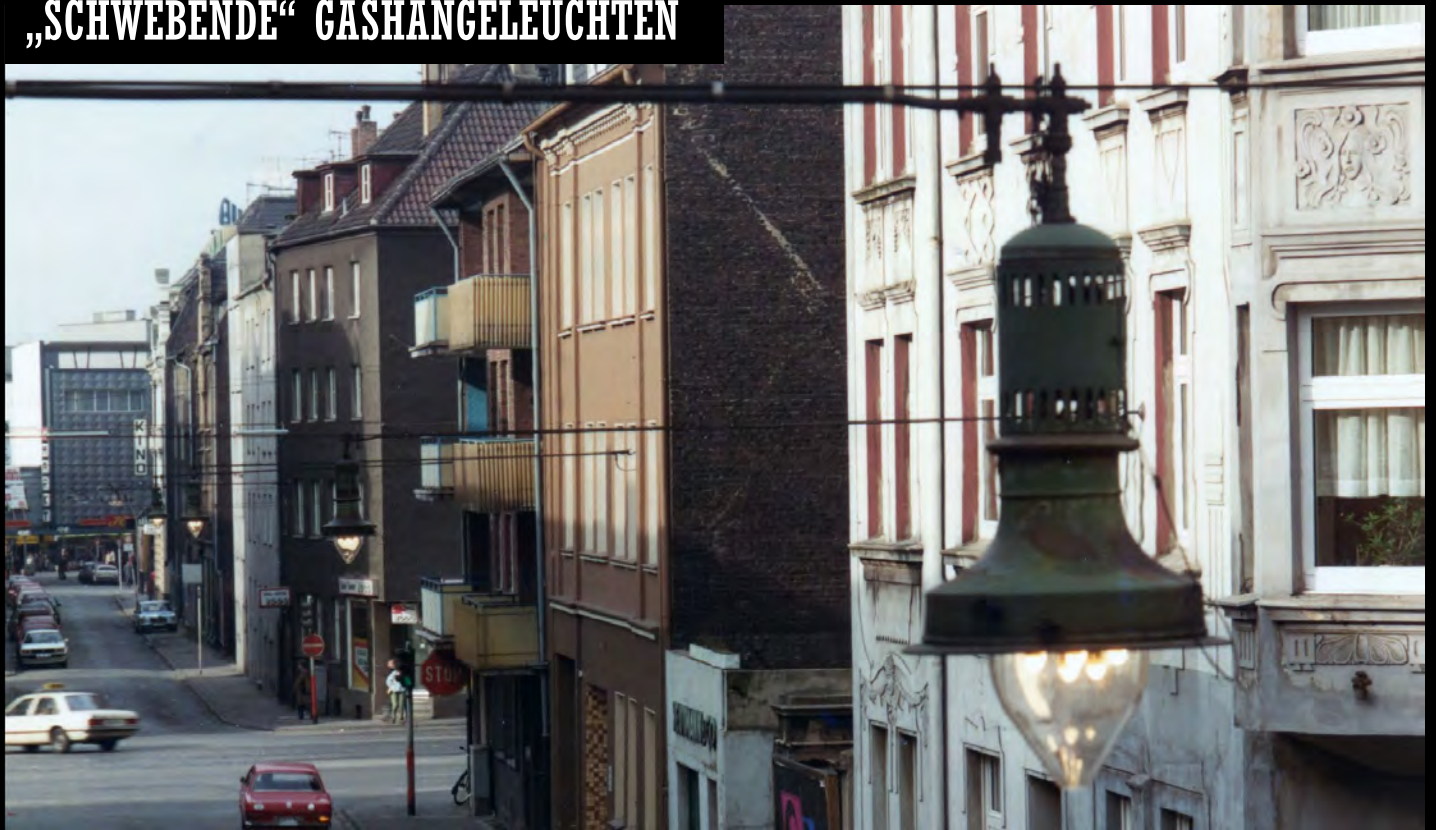
Bis Mitte der 1980er Jahre konnte man in Gelsenkirchen Gashängeleuchten bestaunen, die an Überspannungen über der Straße angebracht waren. Oben die neunflammige Rech-Gashängeleuchte Modell Bielefeld in der Augustastraße; unten die Gasleuchte von Stein & Vendel, eine Hänge/Reihenleuchte mit zehn Flammen. Sie gab es nur in Gelsenkirchen wie hier in der Beskenstraße. Bilder Dieter Grundmann
