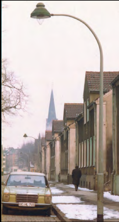
Oben: GICS Modell Neulicht-52 mit Auer P40-Glocke; GICS Modell Neulicht-52 an Benteler-Auslegermast, Lichtpunkthöhe 5m; Ausleger 1,25 m; rechts GICS Modell Neulicht-konvex. Bilder links Klaus Gevatter, in der Mitte Dieter Grundmann, rechts Forum Gelsenkirchener Geschichten
