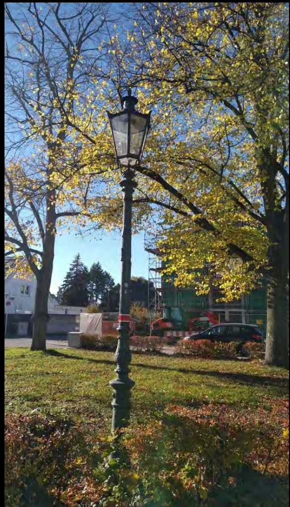
Gasleuchte mit rotem Ring, das Zeichen für teilweise nächtliche Abschaltung. Bild Initiative Düsseldorfer Gaslicht
