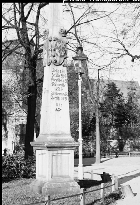
Der Tischerplatz mit der kursächsischen Postdistanzsäule, die dort seit 1905 stand, seit 1956 befindet sie sich an der Jacobäer Straße. Daneben ein Bündelpfeilmast mit einer sechseckigen Magdeburger Modelleuchte, jedoch mit veränderter Entlüftung; rechts am Klosterplatz eine sechseckige Wand-Gaslaterne ähnlich der Dresdner Modelleuchte.
