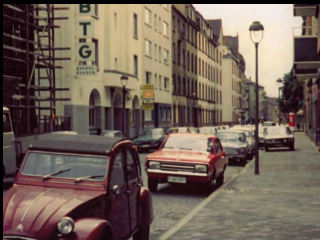
In der Marburger Straße in Bockenheim stehen Schneider-Gasaufsatzleuchten „Modell 52“ im wechselseitigen Verbund auf beiden Straßenseiten. Bild Bettina Raetzer-Grimm
