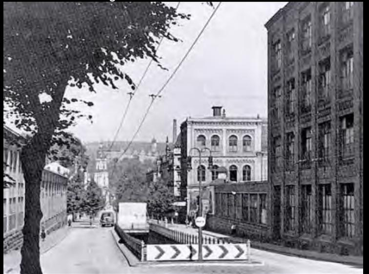
Bei den in Greiz aufgestellten Kandelabern sind vor allem zwei unterschiedliche Modelle zu unterscheiden: Einmal ein runder Kandelaber mit viel Zierrat, nach oben hin stark verjüngend, der Sockel mit einer Breite von etwa 45 cm. Zum anderen ein etwas schmalere, sechseckiger Gusskandelaber. Beide Typen waren etwa drei Meter hoch. Der traditionelle Farbanstrich war schwarz.
