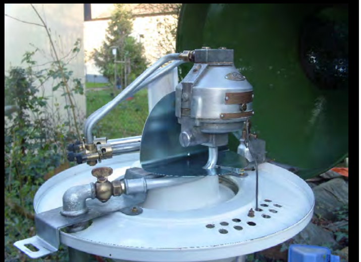
Bilder rechts oben und unten: Bamag-Aufsatzleuchte U 10 mit kleinem „Fuß K“, Stadtgas-Dacheinbau mit Meteorit-Zünder und Bamag-Regulierdüsen.
