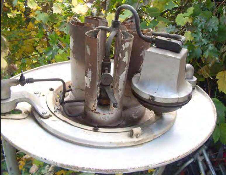
Oben: Dacheinbauten der GICS-Leuchten mit Meteor-Fernzündler aus der Vorkriegszeit. Links Modell Köln mit dreigeteiltem Invertkamin. Jeder Glühkörper hat eine eigene Zündflamme; rechts Modell Wartburg mit Gruppenbrenner 4-flammig. Bilder: Klaus Gevatter
