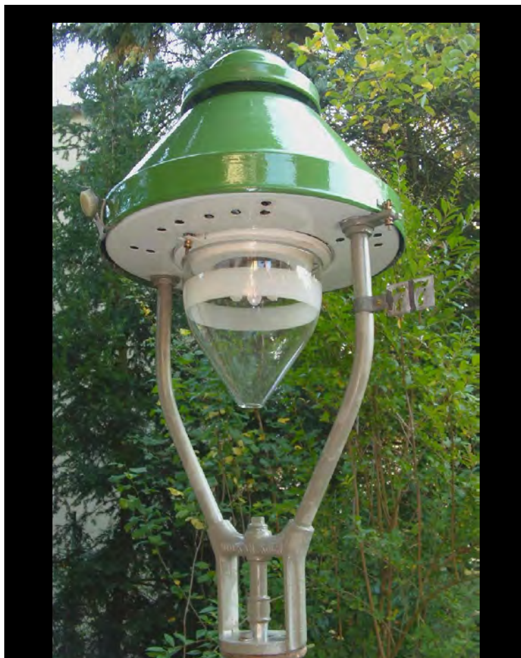
Auf druckwellenlosen Erdgasbetrieb umgestellte Vulkan G 87, mit elektronischem Dämmerungsschalter von Kalin Feinbau Frankfurt/M. Frühe Ausführung mit Funkenzündung und einer nur während des Zündvorgangs halbminütig brennenden Zündflamme. Man erkennt vorn den Motorschaltblock, links den Schaltkasten mit Batterie, rechts den Funkengenerator und in der Mitte die Düse der funkengezündeten Zündflamme. Bilder: Klaus Gevatter
