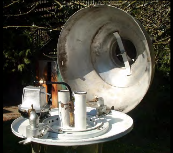
Oben: Dacheinbauten der GICS-Leuchten mit Meteor-Fernzündler aus der Vorkriegszeit. Links Modell Köln mit dreigeteiltem Invertkamin. Jeder Glühkörper hat eine eigene Zündflamme; rechts Modell Wartburg mit Gruppenbrenner 4-flammig. Bilder: Klaus Gevatter
