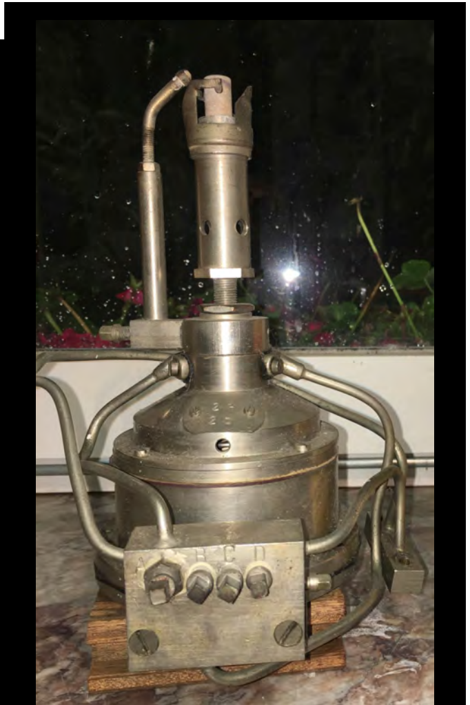
Pneumatischer Kennungsgeber mit Brenner und Zündflamme: Dieses kleine technische 'Wunderwerk' erzeugt, platt gesagt, das Blinken der Lampe allein durch das durchströmende Gas, das durch eine sehr ausgekochte Anordnung von diversen Membranen und Ventilen geleitet wird und hierbei letztendlich das Gasventil zum Glühstrumpf in einer bestimmten Abfolge öffnet und schließt, so dass die Lampe mit ihrer charakteristischen 'Kennung' blinkt.
