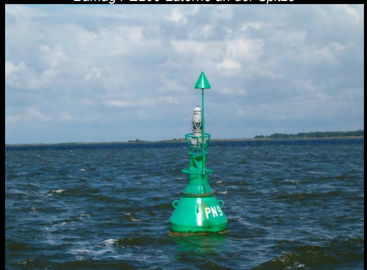
Mit Propangas betriebene Seetonnen. Man beachte den Größenunterschied. Links: Komplette Leuchtboje mit Pintsch-Bamag PE200-Laterne an der Spitze
