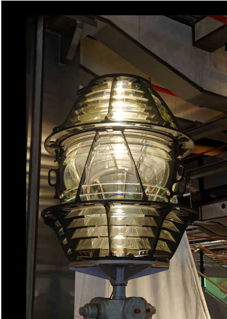
Modell einer Fresnellinse (nicht für die beschriebenen Seetonnen) im Deutschen Technikmuseum Berlin.
