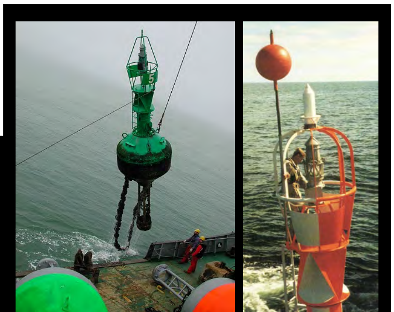
Mit Propangas betriebene Seetonnen. Man beachte den Größenunterschied. Links: Komplette Leuchtboje mit Pintsch-Bamag PE200-Laterne an der Spitze
