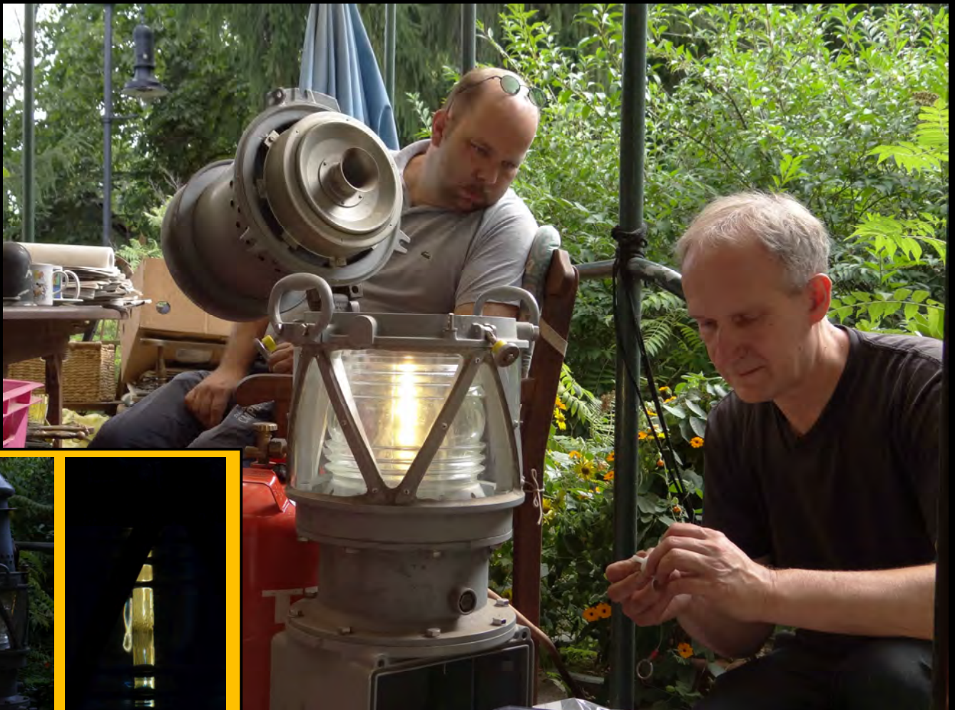
Inbetriebnahme einer Pintsch-Bamag-Seelaterne im Sommer 2019. Rolf Kukula (rechts) und Andy Köppler beim Einstellen. Kleine Bilder links: Durch die Fresnellinse wirkt das Gasglühlicht wie ein senkrechter, hell leuchtender Strich. Bilder: Bettina Raetzer-Grimm
