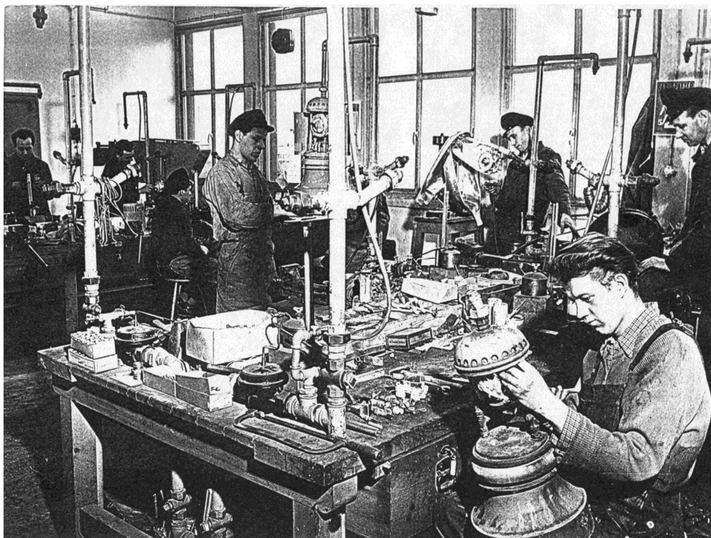
Gaslaternenwerkstatt in den 1950er Jahren. Vorn wird gerade an einer 4-flammigen Graetzin-Hängeleuchte gearbeitet. Im Hintergrund eine Reihenleuchte am Montagegeständer.
