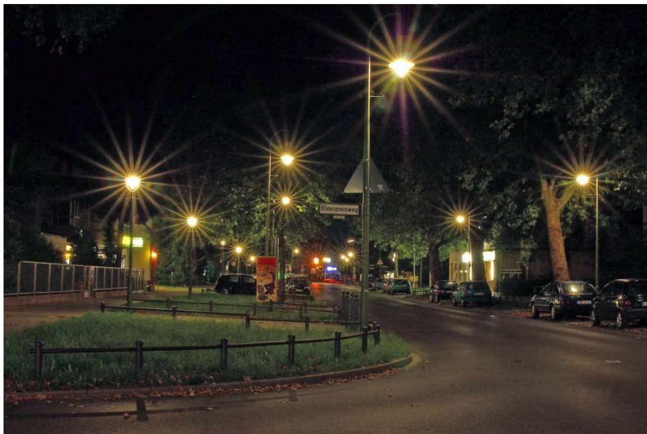
Funkelnd, strahlend, gepflegt, einfach schön! So war Berlins Gasbeleuchtung in den 1990er Jahren. Hier eine um 1989/90 neu angelegte Gaslichtanlage in Alt-Rudow, Hängeleuchten für die Fahrbahn, Aufsatzleuchten für den Gehweg.
