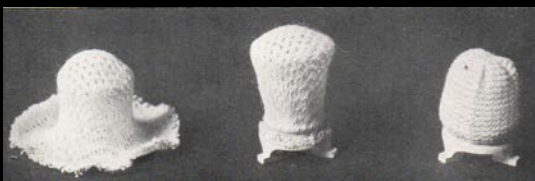
Oben links und Mitte: Spinnelos, gestanz, unabgebrannt; rechts Spinnestrumpf unabgebrannt
