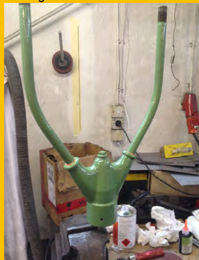
Oben: Montage der Lyren mit orangefarbenen Gewindekleber und Ausrichten der Lyrröhre. Der Strich an der Wand wurde genau wie das Rohr im Schraubstock mit der Wasserwaage eingerichtet. Durch Drehen der gesamten Lyra um 180° wurden die Rohre zueinander und mit dem Strich an der Wand verglichen. Bilder: Nico Kiefer
