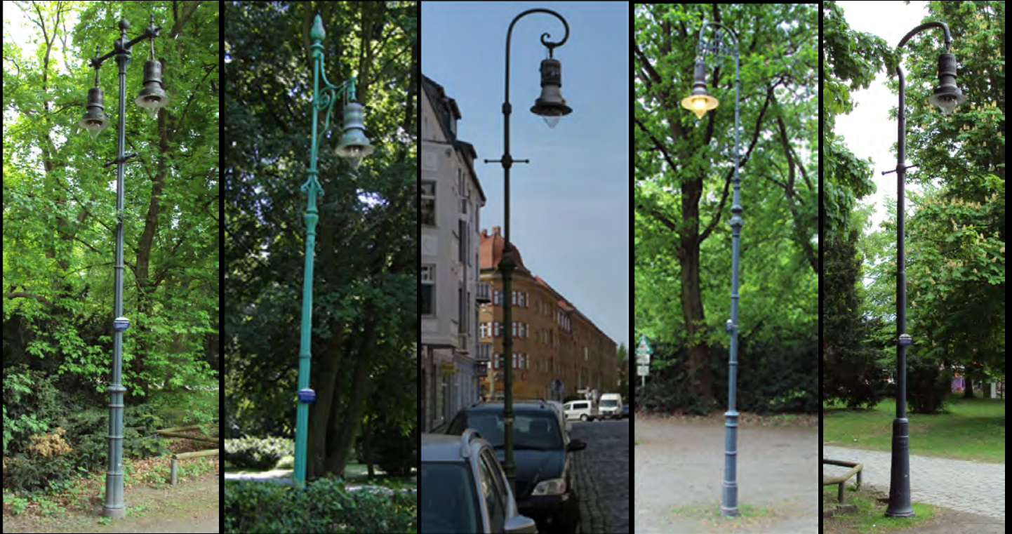
Von links: Doppel-Galgen (1906); Jugendstil-Kandelaber (um 1910); Bündelpfeiler mit Bischofsstab-Ausleger (um 1920); Bündelpfeiler mit bogenförmigem, verziertem Ausleger (um 1920); Schwanenhals-Mast (1926);
