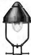
AIDA Propangas-Aufsatzlampe Nr. P. 173 Ausführung: Gehäuse Eisen, schwarz emailiert, Reflektor innen weiß emailiert, Außenkörper Eisen, schwarz lackiert.
