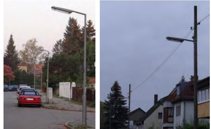
Oben: Die Langfeldleuchte wurde ab 1955 massenhaft im Westteil Berlins aufgestellt. Den konischen Masten mit ihren zylindrischen Sockeln wurden Ausleger angeschweißt, meist mit einer leichten Anstellung von fünf Prozent. Es existieren aber auch gerade (im rechten Winkel) angeschweißte Ausleger. Holzmaste mit Freileitung wurden ebenfalls verwendet und sind bis heute anzutreffen. Unten: Die neuerdings in großen Stückzahlen montierte LED-Leuchte. Bilder: Bettina Raetzer-Grimm
