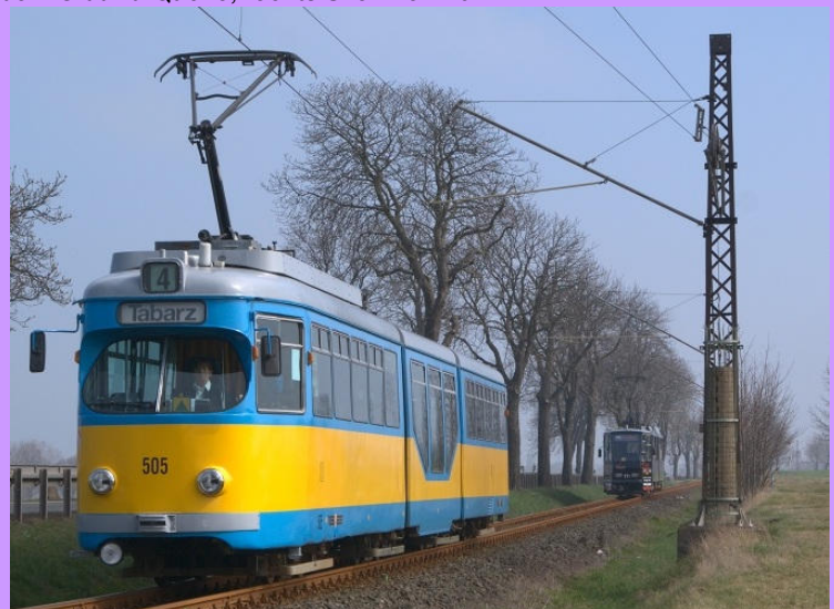
Links: Zwei verschiedene Gittermaste auf der landschaftlich reizvollen Strecke der Überlandstraßenbahn von Ludwigshafen nach Bad Dürkheim (Rhein-Haardt-Bahn, um 2015), im Hintergrund der Pfälzer Wald; rechts Vierkantgittermast mit Gewichten zur Fahrdrahtbespannung und modernem Ausleger, ähnlich den heute üblichen der Deutschen Bahn AG. (Thüringerwaldbahn).
