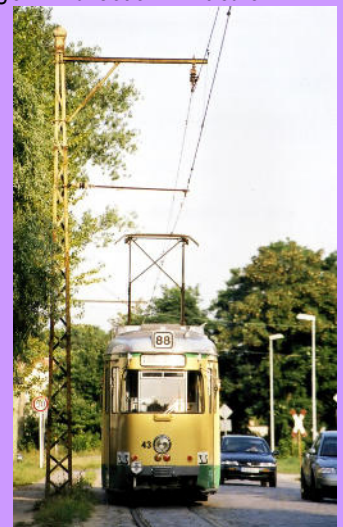
Oben: Ausleger für Kettenfahrlleitung. Links technische Zeichnung von Siemens; rechts Mast in Schöneiche b. Berlin. Quelle: Slg. PGL
