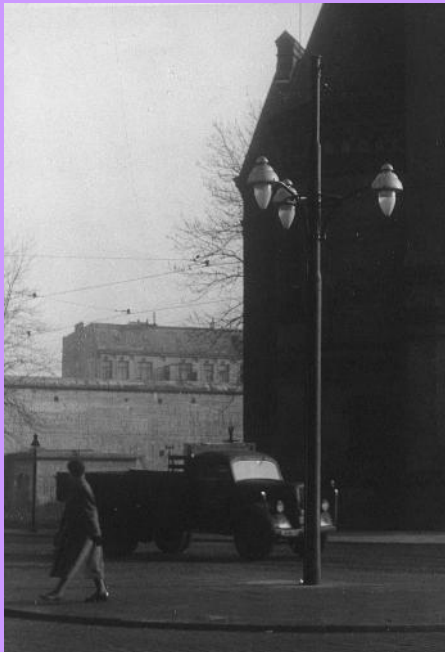
Hamburg: Oben Mast mit drei Maxilux-Ansatzleuchten; unten sogar mit vier, Hersteller Firma Rech. Bestückung mit Blohm-Glocken. Auch die Richtungspfeilschilder sind gasbeleuchtet.
