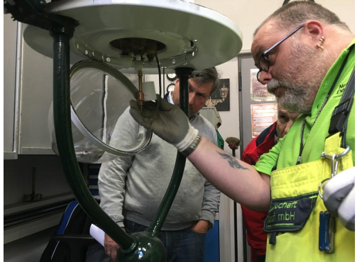
Wie funktioniert Gaslicht? Hans-Peter Klapdor (rechts) demonstriert die Wartung einer Gaslaterne mit dem Austausch der Glühkörper.
