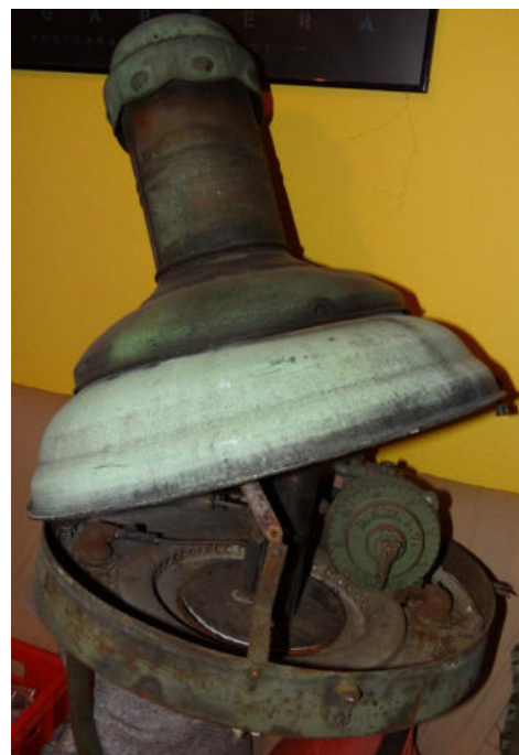
Oben: Rech-Aufsatzleuchte „Modell Frankfurt“ mit BAMAG-Fernzündler der 1. Generation (große „Einstellnase“), Bild: Slg. ProGaslicht
