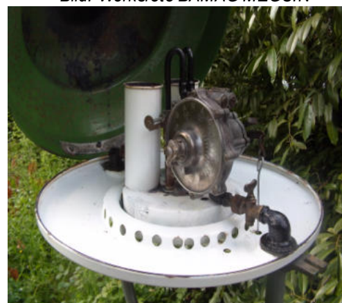
Rech-Aufsatzleuchte aus Karlsruhe mit BAMAG-Fernzündler der 3. Generation (acht Schrauben), Bild: Klaus Gevatter
