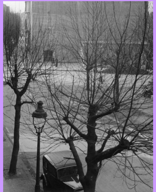
Oben: Eine Gasaufsatzleuchte „Modell Köln“ in den 1930er Jahren, montiert auf einem sogenannten Stühlen-Kandelaber, im Hintergrund ein Hochbunker. Bild: Bundesarchiv 183-1984-0131-506; unten: Bei dieser Gasleuchte wurde das Untergestell bereits verändert, der Jugendstil-Bügel fehlt, dafür besitzt die Leuchte eine Lyra mit Ringbügel. Das Bild entstand 1954 am Volksgarten, Quelle: unbekannt/Slg. PGL
