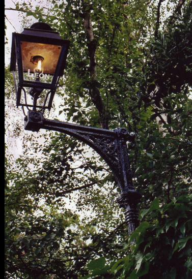
Dreimal Gaslicht aus Frankreich: V.l.n.r. Offene Flamme bei einer Gas-Ausstellung in Lille 1995; Gasstraßenleuchte mit Stehlicht in Malakoff bei Paris (2011) und sechsflamrige Gasleuchte mit heute üblichem hängendem Gasglühlicht in Sarlat-la-Canéda (2013). Bilder: Sammlung ProGaslicht
