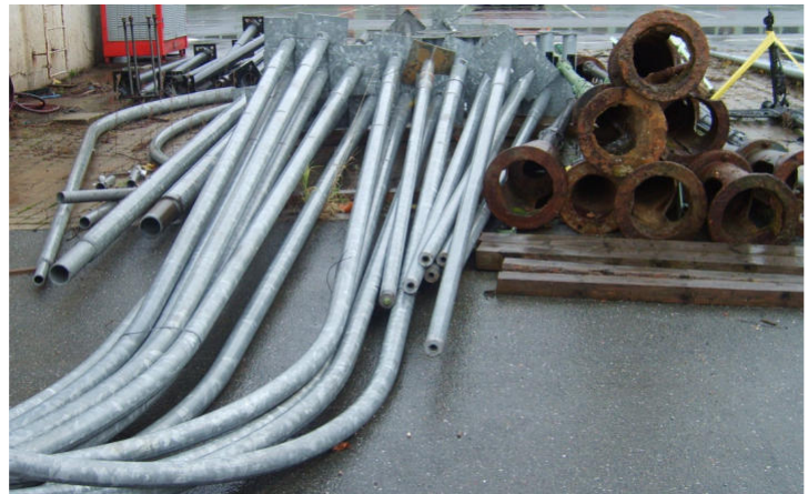
Gasmaste für Aufsatz-, Ansatz- und Reihenleuchten. Rechts gusseiserne Erdkörbe. Bild: Joachim Raetzer
