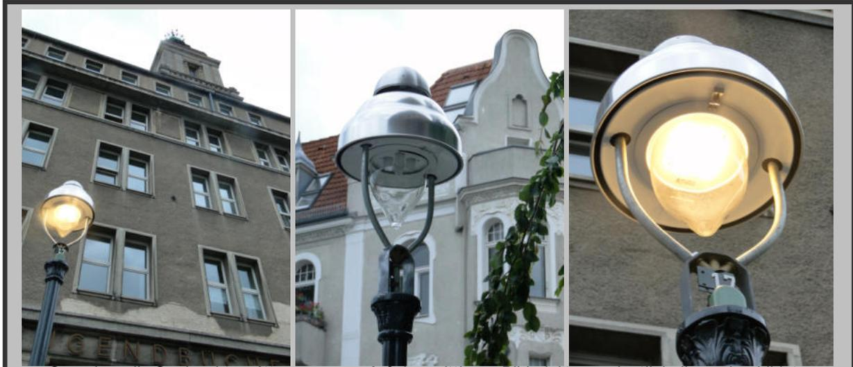
*So sehen die Gasleuchten-Attrappen aus. Auf dem mittleren Bild sieht man deutlich die nachgebildeten Glühkörper, kleine Hütchen aus Glas, unter denen die Leuchtdioden versteckt sind. Als Ersatz für veraltete und/oder hässliche Elektroleuchten sicherlich geeignet, nicht aber als „Gasersatzleuchte“, ein Begriff, den die Verwaltung offenbar erfunden hat. Bilder: Bettina Grimm*
