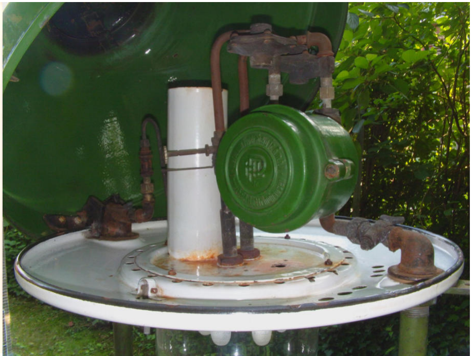
Links: Titelblatt eines Prospektes der Firma Pipersberg; rechts eine in einer Aufsatzleuchte eingebaute Pipersberg-Uhr.
