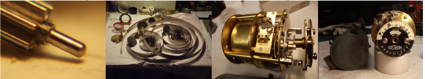
Dritte Reihe v.l.n.r.: Achszapfen vor der Überholung; Federwerk; Uhrwerk nach der Überholung; Uhrwerk auf dem Prüfstand
