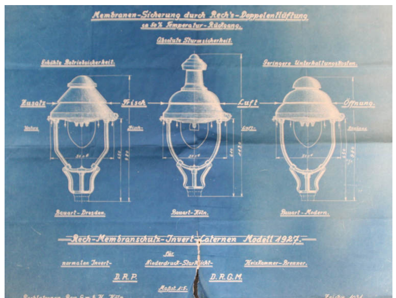
Rech-Gasaufsatzleuchten aus dem Firmen-katalog. Links beide Varianten (Modelle A und B); rechts eine Blaupause aus dem Jahr 1927 mit späteren Modellen. Während das Modell „Köln“ in ihrem Maßen die größte Laterne ist, wirken die Modelle „Dresden“ (links) und „Modern“ (rechts) etwas gedrungener. Beide letztgenannten Modelle existieren heute. Modell „Dresden“ in kleinen Stückzahlen in Düsseldorf und Bonn, das Modell „Modern“ wurde zu einer der meist verkauften und installierten Gasaufsatzleuchte überhaupt. Aktuell in Worms, Würzburg und Bad Homburg. Bilder: Slg. Klaus Gevatter
