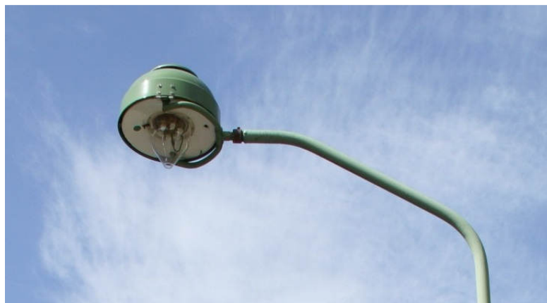
Nur in Frankfurt am Main zu sehen: Die Gasleuchte der Firma Gebrüder Schneider aus Hamm/Westfalen aus dem Jahr 1952 – wahlweise als Auf- oder seitlich angebrachte Ansatzleuchte. Die Reihenleuchte des gleichen Herstellers aus dem Jahr 1956 ist in Frankfurt und Düsseldorf anzutreffen.
