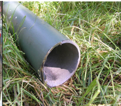
Bilder oben und unten: Auf der Hansaallee war über einen längeren Zeitraum das Gasleuchten-Gemetzel zu beobachten. 137 Gasreihenleuchten wanderten trotz ihres sehr guten Zustandes in den Schrottcontainer. Wie sehr deutlich zu sehen ist, sind keine Korrosionsschäden an den Gas führenden Stahlmasten zu erkennen. Behauptungen, dass solche Gasmasten wegen nachlassender Standsicherheit in großer Zahl entfernt werden müssten, entbehren jeder Grundlage. Bilder: Thomas Schmitz
