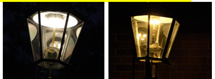
Bild links: Eine Modelleuchte mit LED-Einsatz, der Fernzünder dient als Attrappe; rechts das Original. Gasgühlicht mit aktivem Bamag-Fernzünder, Bilder: Joachim Raetzer
