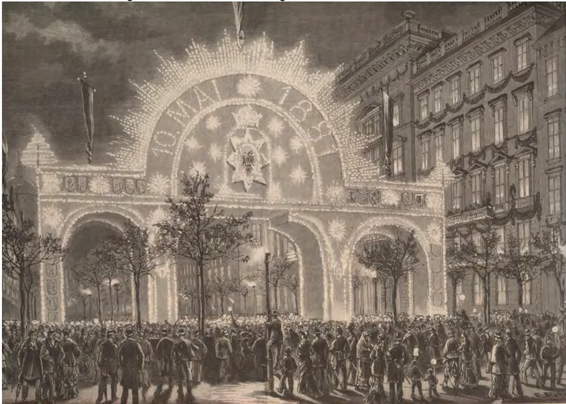
Die Vermählungsfestlichkeiten in Wien: Der Triumphbogen der Gasgesellschaft auf dem Kärntnerring, Zeichnung von Ladislaus Eugen Petrovits (1839-1907), Bild: Sammlung PGL. Gut zu erkennen ist im Vordergrund der Bündelpfeilermast ohne montierte Laterne, dafür mit Gasfackel. Ein Mann ist ein Stück nach oben geklettert. Im hinteren Bereich weitere Bündelpfeiler mit Gasfackeln.
