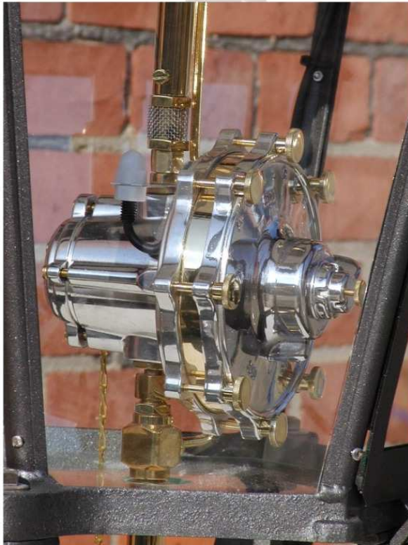
In diesem Nachbau des BAMAG-Fernzünders ist ein elektronisches Schaltgerät versteckt. Bild: Sammlung ProGaslicht
