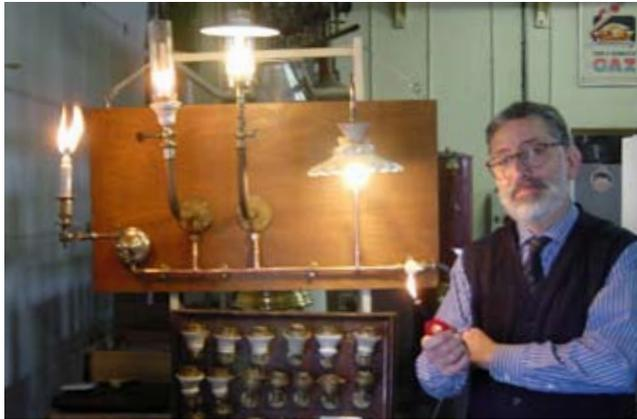
**M. Ara mit einer Auswahl von Gasbrennern: Schnitt-, Rund-, Stehlicht- und Hängelichtbrenner**
